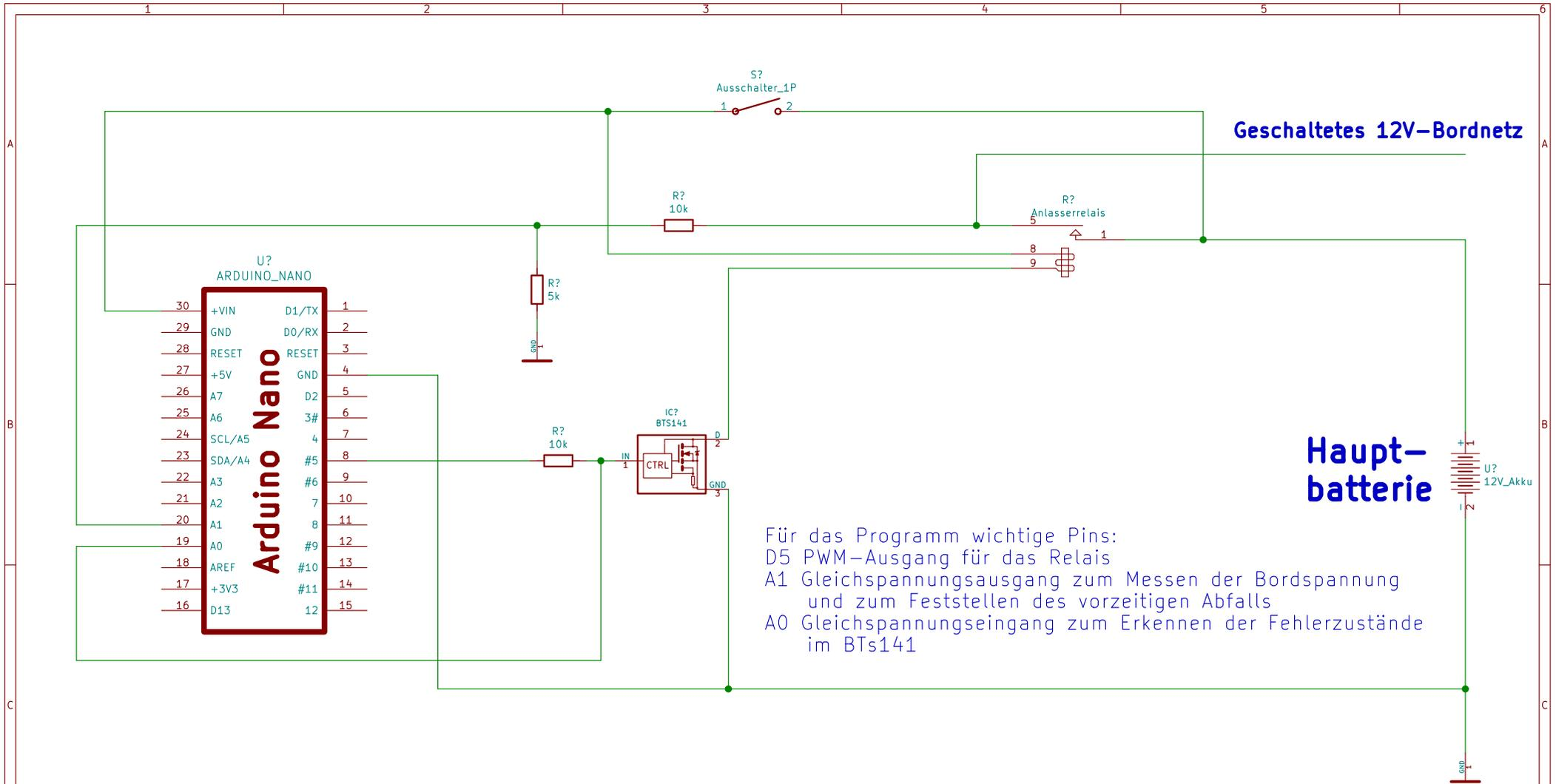
Der PWM-Automat dient hier zum stromsparenden Betrieb eines großen Relais. Im Normalbetrieb wird das Relais mit 100% PWM angezogen, anschließend wird das PWM bis zu einem voreingestellten Wert reduziert. Im weiteren Betrieb wird das PWM entsprechend der Spannungshöhe angepasst, also bei Spannungseinbrüchen erhöht, und bei hohen Spannungen vermindert. Fehlerzustände werden erkannt:
